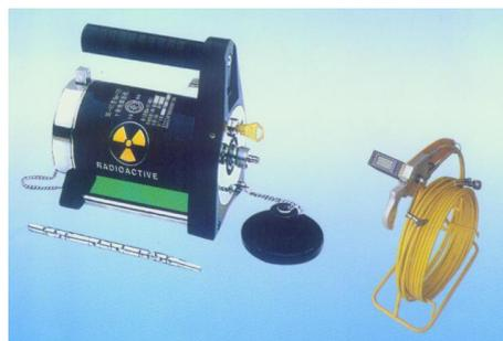
图 9-6 常见  $\gamma$  射线探伤机外形示意图
